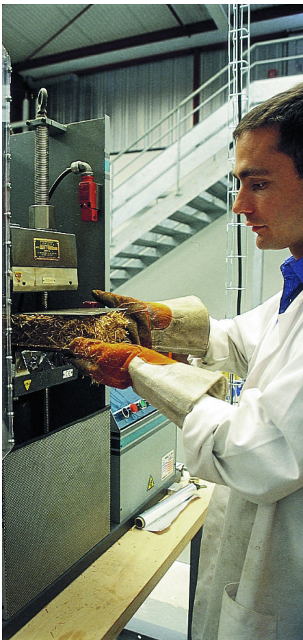
L'un des programmes d'Europol'Agro : élaboration d'agro-matériaux à base de paille de blé et d'une colle dérivée d'huile végétale.
